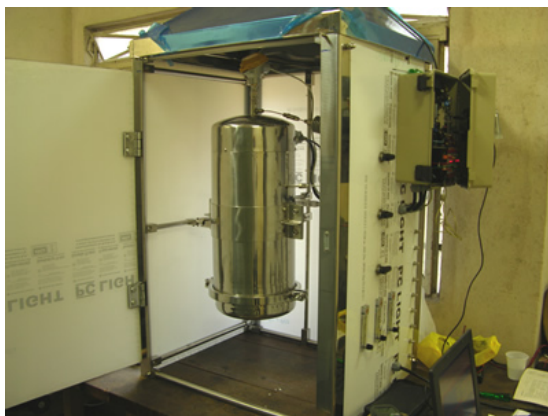
Figura 3 - Reator de Pirólise
