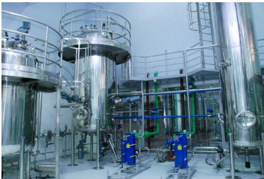
Figura 4 - Planta piloto da Amyris para a produção de diesel renovável (Tecnologia Biofene®), em Campinas, SP
